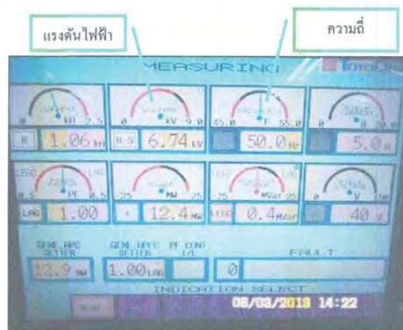
รูปที่ 5 แสดงหน้าจอแรงดันไฟฟ้าและความถี่ทางไฟฟ้าที่จอสามค่า
